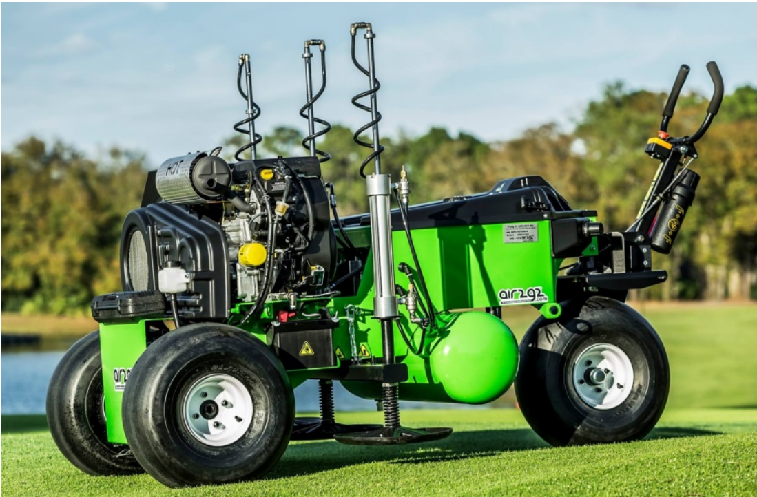
Abbildung 5: Diskontinuierlich arbeitendes Gerät zur Bodenlockerung mit Druckluft, Air2G2 [Bildquelle: http://www.air2g2.com/ ]
