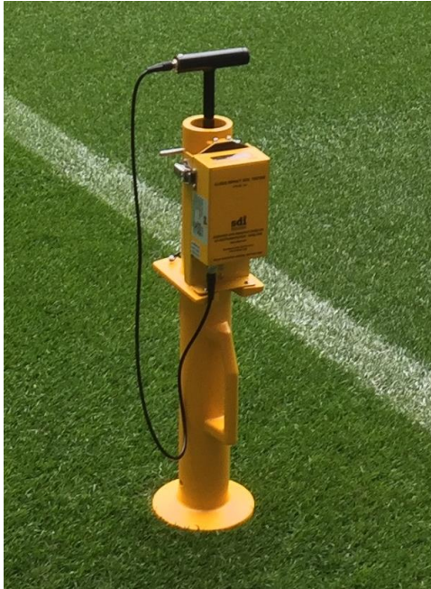
Foto 1: Clegghammer in Arbeitsposition auf einem Stadionrasen.
