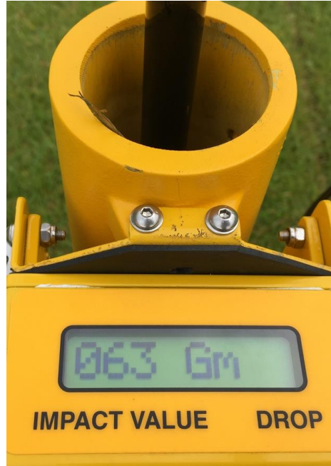
Foto 2: Digitale Anzeige und Speicherung des Messwertes bieten direkte Information und spätere Dokumentation.
