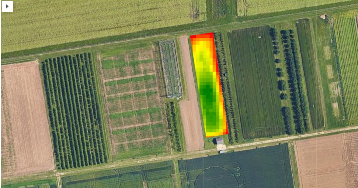
Abbildung 15: Normalized Difference Vegetation Index (NDVI) des Rasenversuchsfelds an der Universität Hohenheim. Mittelwerte des Zeitraums März 2021-Jul.2022. Untere Hälfte zeigt Mähroboter geschnittene Fläche. (Datenaufbereitung und Visualisierung: Greenway by Karuna Technology). Skalierung nicht bekannt.
