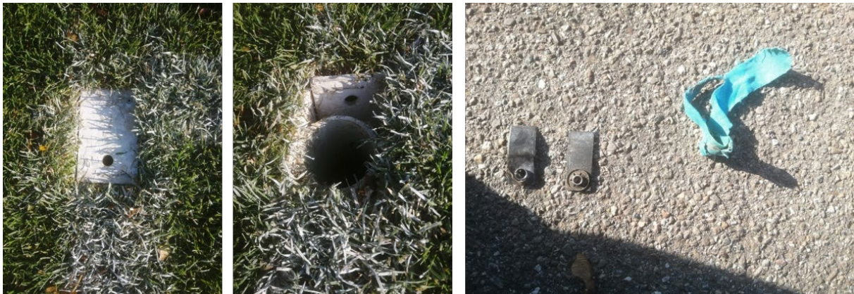
Abbildung 21: Rasenspielfeld (Sportplatz). Links: abgedeckte Hülse für Eckfahne kann problemlos vom Mähroboter überfahren werden. Mitte: Gleiche Hülse mit senkrecht platzierter Abdeckung nach einem Spiel führte zu Schäden an den Messern (rechts). Rechts: beschädigte Messer und Tape-Reste von blockiertem Mähkopf.
