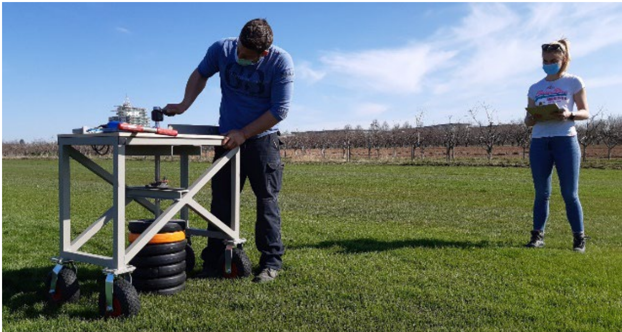
Abbildung 5: Stollenschergerät-Eigenbau nach EN 15301-1:2007 auf dem Rasenversuchsfeld in der Versuchsstation Agrarwissenschaften der Universität Hohenheim.
